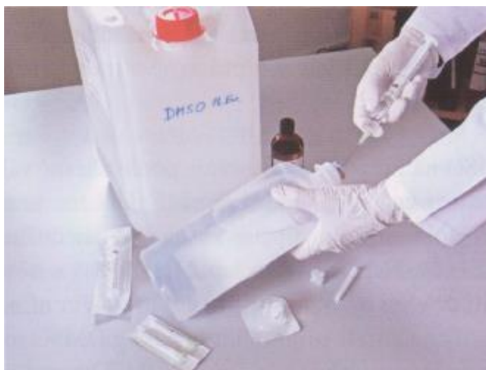
Obr. č. 33: Vstříknutí čistého DMSO skrz septum
