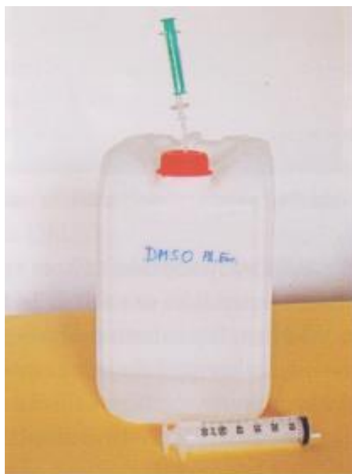
Obr. č. 13: Kanýstr se systémem odběru a filtrem
